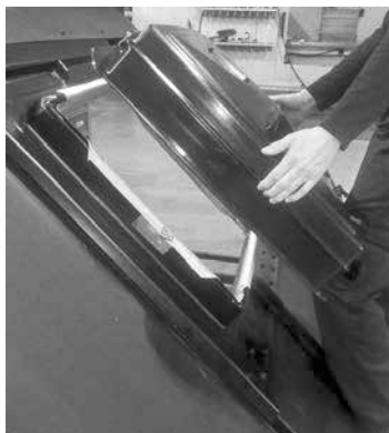
e. Kattoluukun liittäminen pohjaosaan.
