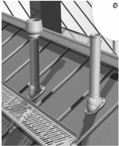
Kuva 41. Läpivientielementtien sijainti lappeella.
