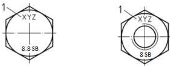
Kuva 10. Esimerkki ruuvien ja mutterien merkinnästä.
