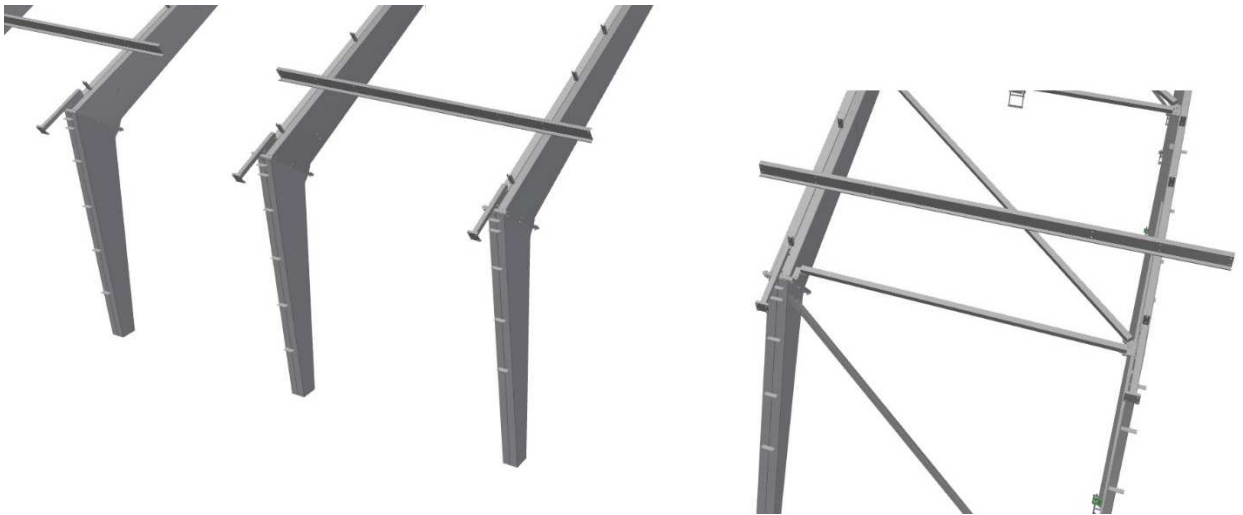
Kuva 17. Orsirivin joka toisen orren kiinnitys.
