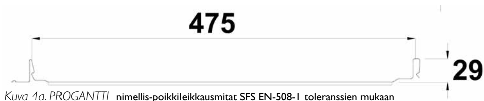
Kuva 4a. PROGANTTI nimellis-poikkileikkausmitat SFS EN-508-I toleranssien mukaan
