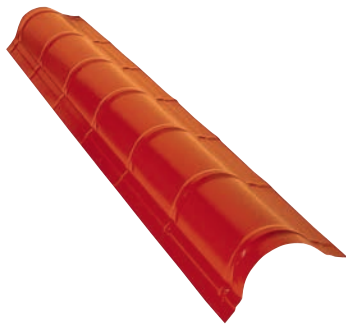
MUOTOHARJALISTA 180 x 180, L = 1 930 suositellaan kattokalveuuksille loivempi kuin 1:2
