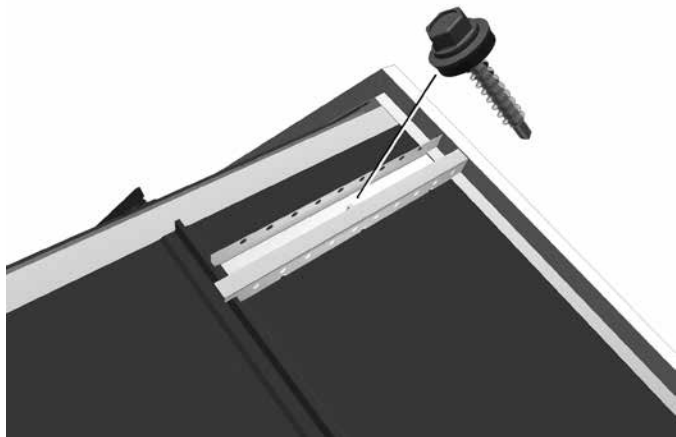
Kuva 33. Progantti harjan tiivistyslistan kiinnitys.
