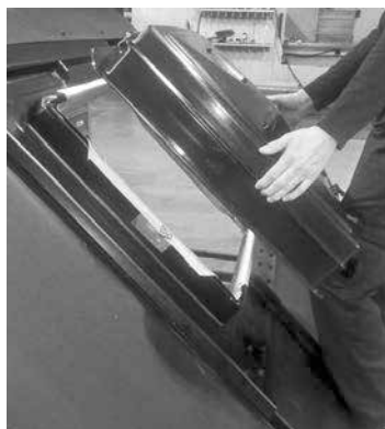
e. Kattoluukun liittäminen pohjaosaan.
