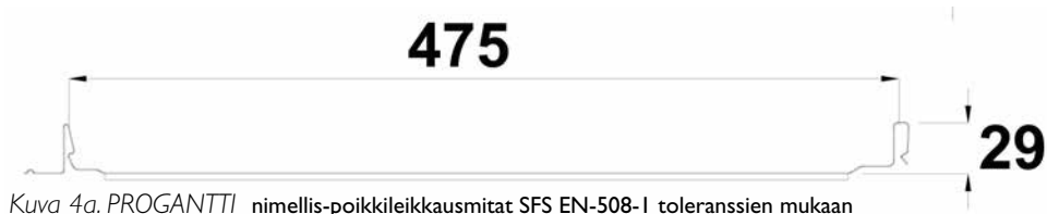
Kuva 4a. PROGANTTI nimellis-poikkileikkausmitat SFS EN-508-I toleranssien mukaan
