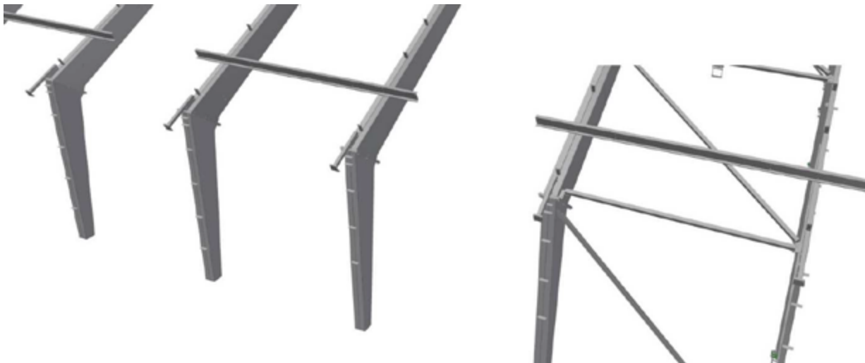
Kuva 17. Orsirivin joka toisen orren kiinnitys.
