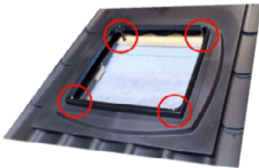
Kuva 45. Pohjaosan kiinnitys ruoteisiin, holkkien läpi ruuvatuilla ruuveilla
