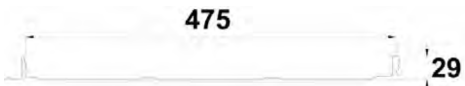
Kuva 4b. PROGANTTI J nimellis-poikkileikkausmitat SFS EN-508-1 toleranssien mukaan
