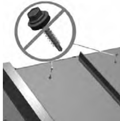
Kuva 18. Älä ruuvaa katelevyjä yläpäästä ruoteeseen
