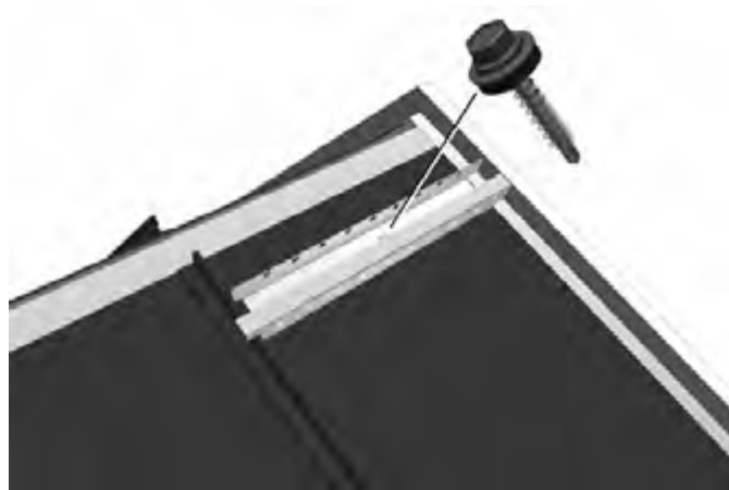
Kuva 31. Progantti harjan tiivistyslistan kiinnitys.
