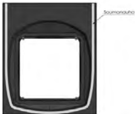
Kuva 43. Saumanauhan kiinnitys pohjaosaan
