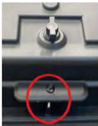
Kuva 49. Kattoluukun lukitus ja ruuvi varmistus
