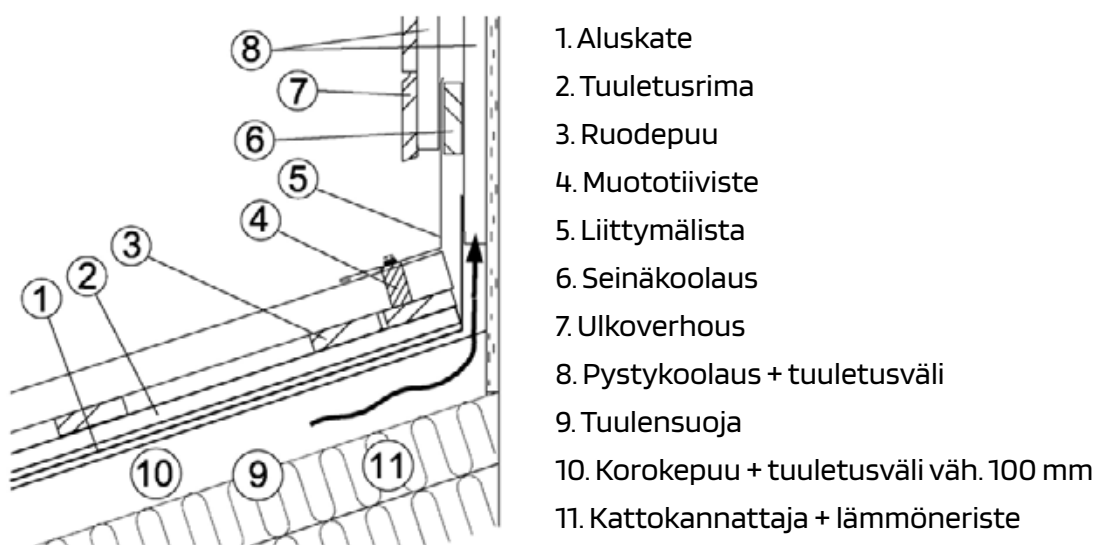
Kuva 5. Katon ja seinän liitos.
