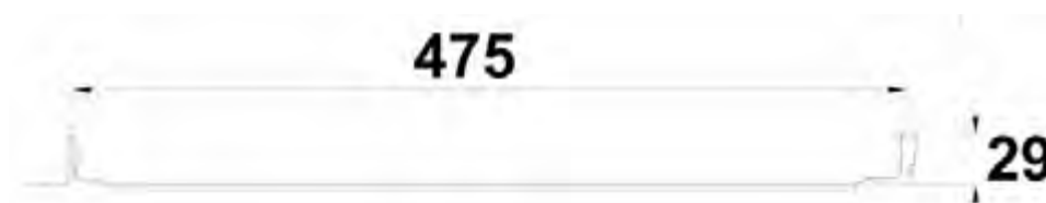
Kuva 4a. PROGANTTI ja PROGANTTI Acoustic Pro nimellis-poikkileikkausmitat SFS EN-508-1 toleranssien mukaan
