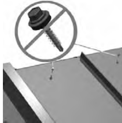
Kuva 18. Älä ruuvaa katelevyjä yläpäästä ruoteeseen
