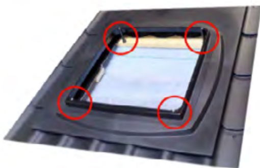
Kuva 45. Pohjaosan kiinnitys ruoteisiin, holkkien läpi ruuvatuilla ruuveilla
