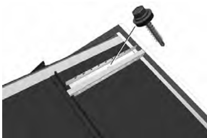
Kuva 31. Progantti harjan tiivistyslistan kiinnitys.
