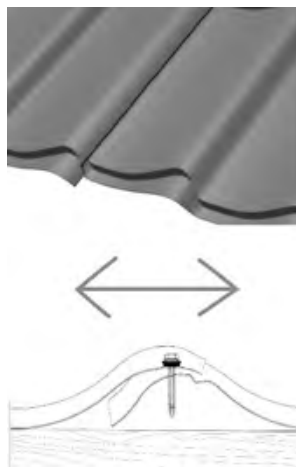
Kuva 17a. Väärin asennettu limitys.
