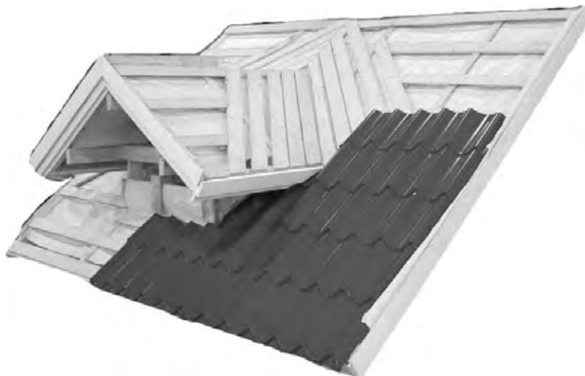
Kuva 25a. Asenna räystäälle muotolevy, joka ulottuu lappeen suunnassa vähintään 400 mm jiirin loppukohdan yläpuolelle.
