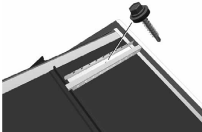
Kuva 31. Progantti harjan tiivistyslistan kiinnitys.
